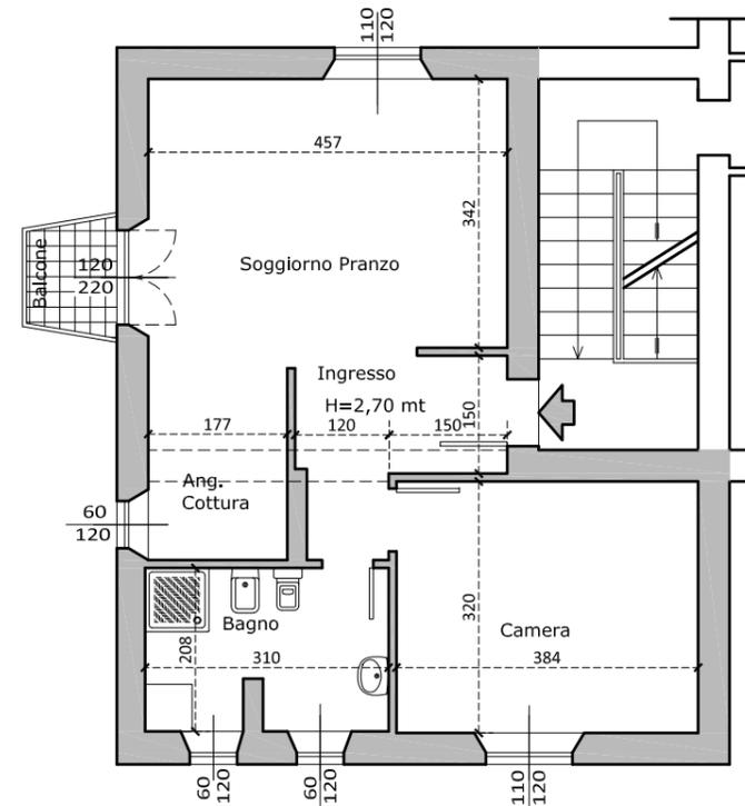
PIANTA PIANO TERZO - STATO DI PROGETTO
